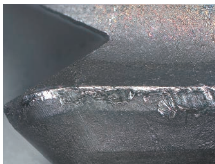
Az él állapota a megmunkálást követően
